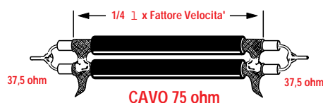
Fig.3 Per utilizzare un cavo di discesa da 52 ohm, dovete collegare tra i due dipoli e il cavo di discesa, un trasformatore elevatore d'impedenza che si ottiene collegando in parallelo due spezzoni di cavo coassiale da 75 ohm lunghi 1/4\lambda .
