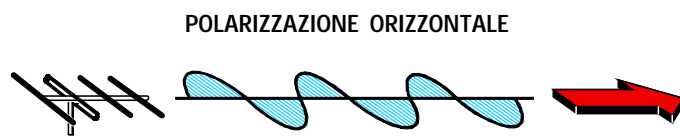
Fig.31 Collocando un dipolo in posizione orizzontale, le onde radio si propagheranno con una polarizzazione orizzontale rispetto al suolo.
