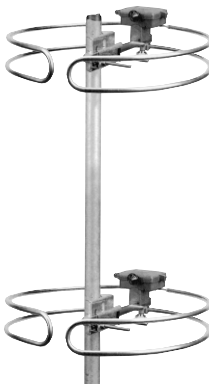
Fig.4 Collegando due folded-dipoli in fase o in opposizione di fase è possibile ottenere un guadagno di circa 4,5 dB. All'interno delle due scatole visibili nella foto sono inseriti dei piccoli trasformatori in ferrite, che provvedono ad adattare l'impedenza del folded-dipole sul valore del cavo coassiale utilizzato per la discesa, cioè sui 75 oppure sui 52 ohm.
