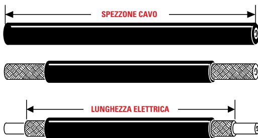
Fig.2 La lunghezza elettrica del cavo è quella ricoperta dalla calza di schermo, quindi quando tagliate lo spezzone di cavo coassiale da 1/4\lambda o 3/4\lambda tenetelo più lungo di 3 cm per poterlo spellare.
