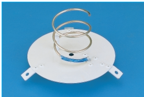
Fig.6 Per aumentare il guadagno di una parabola, si può collocare sul suo fuoco un'antenna elicoidale con solo 3-4 spire.
