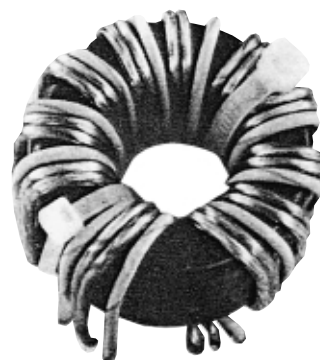
Fig.16 Sui nuclei toroidali il numero delle spire può variare se varia la "miscela" della ferrite. Per questo motivo conviene inizialmente avvolgere 10 spire anzichè 7 e poi controllare con un Rosmetro se togliendo 1-2-3 spire, le onde stazionarie aumentano oppure diminuiscono.
