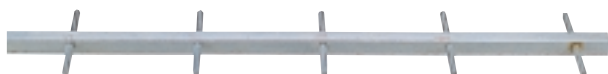
Fig.14 Per le Yagi che lavorano su frequenze maggiori di 300 MHz, se gli elementi vengono fissati sull'asta metallica SENZA isolarli, dovete aumentare la loro lunghezza (in proposito vedi gli esempi riportati nell'articolo).
