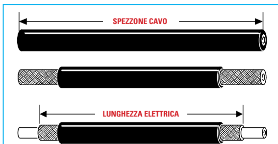
Fig.2 La lunghezza elettrica del cavo è quella ricoperta dalla calza di schermo, quindi quando tagliate lo spezzone di cavo coassiale da 1/4\lambda o 3/4\lambda tenetelo più lungo di 3 cm per poterlo spellare.
