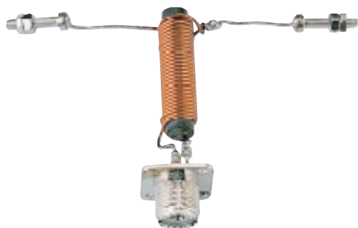
Fig.9 Foto di un trasformatore da bilanciato a sbilanciato avvolto su un nucleo cilindrico in ferrocube.
