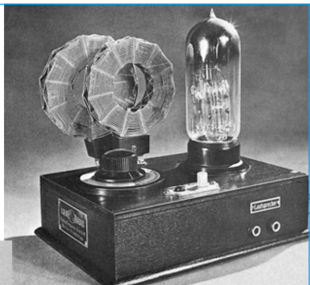
Fig.340 Negli anni 1925-1940 era molto diffuso un semplice ricevitore radio a cuffia chiamato a "galena" perché usava come rivelatore di segnali un minerale di solfuro di piombo contenente un 2% circa di argento.
