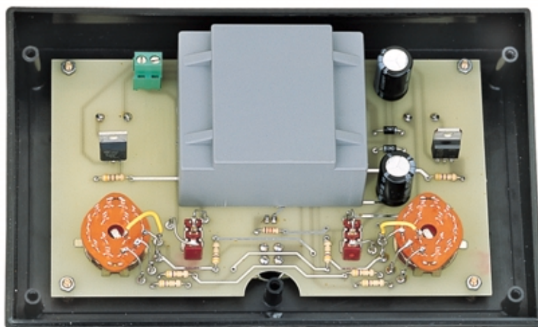
Fig.546 Il circuito stampato va fissato sul pannello del mobile per mezzo dei quattro distanziatori metallici da 5 mm che troverete inclusi nel kit.
