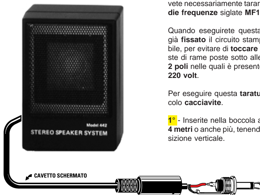
Fig.385 Dalla piccola Cassa Acustica, contenente l'altoparlante, fuoriesce un sottile cavetto schermato. Dopo aver spellato la sua estremità in modo da separare i due fili, dovete saldare quest'ultimi sui terminali del connettore jack maschio inserito nel kit. Arrotolate bene i sottili fili della calza di schermo per evitare che ne rimanga qualcuno volante.
