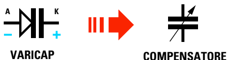
Fig.109 Sulla sinistra il simbolo grafico di un diodo varicap. Questi diodi sono dei piccoli condensatori di capacità variabile.
