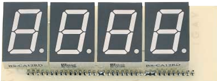
Fig.280 Il punto decimale dei Display va rivolto verso il connettore femmina.
