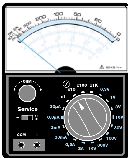
Fig.372 Nella funzione Ohmetro, il valore della resistenza letto sulla scala Ohm andrà moltiplicato per il fattore contrassegnato dalla manopola, cioè x1-x10-x100-x1K. Ogni volta che cambierete portata dovrete cortocircuitare i due puntali e ritoccare il potenziometro di taratura.
