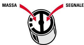
Fig.431 Sul lato posteriore del piccolo microfono sono presenti due piccole piste in rame. La pista collegata al corpo metallico del microfono è quella di massa, mentre la seconda, che risulta isolata, è quella dalla quale dovete prelevare il segnale BF.
