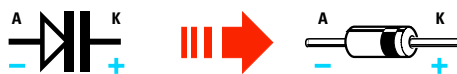
Fig.110 Il terminale K (Catodo) di questi diodi va sempre collegato al positivo di alimentazione tramite una resistenza.
