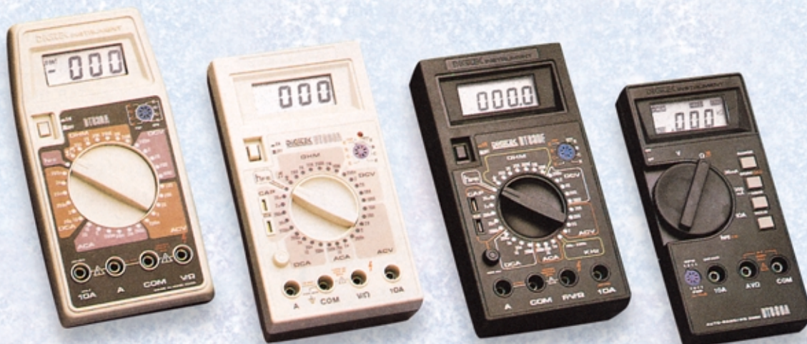
Fig.379 Un buon Tester Digitale deve avere non meno di 4 cifre che in pratica corrispondono a 3 cifre e mezzo, perchè la prima cifra di sinistra non riesce mai a visualizzare un numero maggiore di 1. Scegliete possibilmente un modello che faccia apparire sui display i simboli \Omega - K\Omega - M\Omega - \mu V - V - \mu A - mA , anche se vi costerà un po' di più.
