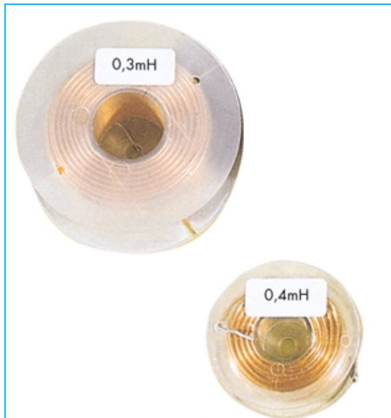
Fig.182 Le induttanze da utilizzare per i filtri Cross-Over si ottengono avvolgendo su un rocchetto di plastica, non importa se tondo o quadrato, un certo numero di spire di filo di rame. Più spire avvolgerete sul rocchetto più aumenterà il valore in millihenry della bobina.
