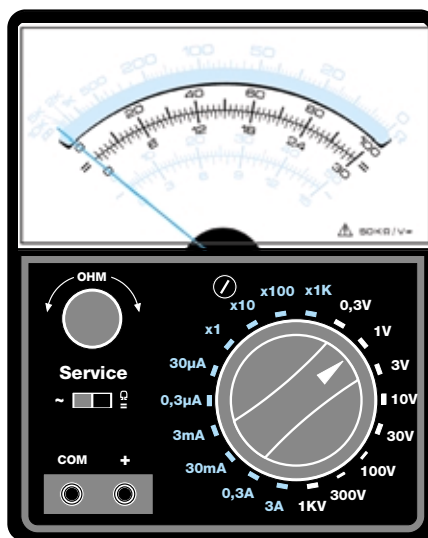
Fig.373 Nella funzione Voltmetro CC, ruotando la manopola sulle portate contrassegnate 0,3-3-30-300 V. il valore andrà letto sulla scala graduata da 0 a 30, ruotando la manopola sulle portate contrassegnate 1-10-100 V. il valore andrà letto sulla scala graduata da 0 a 100.
