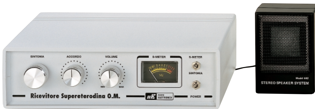
Fig.375 Foto della supereterodina per OM che ora vi insegniamo a montare.
