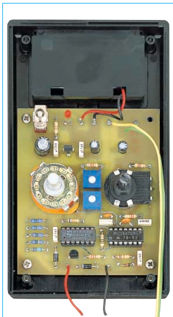
Fig.157 Il circuito stampato andrà fissato all'interno del mobile plastico con 4 viti autofilettanti. Nel vano posto in alto inserirete la pila di alimentazione da 9 volt.
