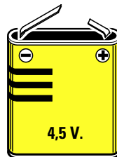
Fig.17 La tensione "continua" si preleva dalle Batterie autoricaricabili, dalle Pile e dalle Celle Solari.
