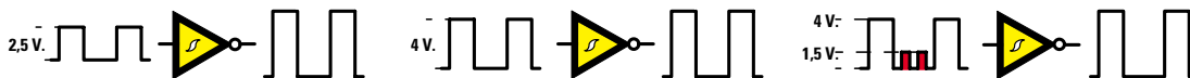
Fig.589 Una porta Inverter Triggerata riconosce come Livello logico 1 solo quei segnali che superano un livello di 2 volt, quindi se sugli ingressi giungono degli impulsi di disturbo che non superano una tensione di 2 volt, non vengono rilevati.
