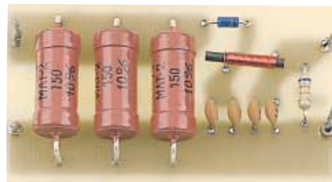
Fig.436 Foto della sonda di carico LX.5042 come si presenta a montaggio ultimato.
