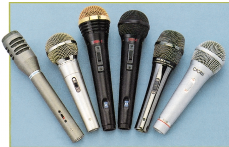
Fig.187 Tipi di microfoni utilizzati dalle orchestre e dai cantanti. I microfoni più usati sono quelli di tipo elettromagnetico e piezoelettrico.
