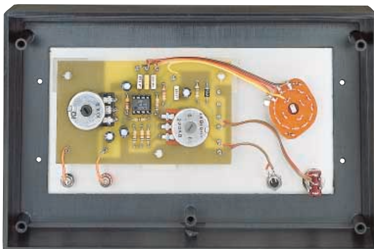
Fig.135 La scheda LX.5031 montata all'interno del suo mobile plastico. Il commutatore rotativo S1, da utilizzare per il cambio gamma, andrà fissato sul pannello frontale.
