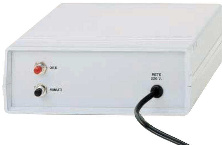
Fig.283 Sul pannello posteriore del mobile fissate i due pulsanti P1-P2.
