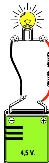
Fig.63 Se applichiamo in serie due resistenze da 10 ohm vedremo ridurre notevolmente la luminosità della lampadina perché avremo dimezzato il flusso degli elettroni.
