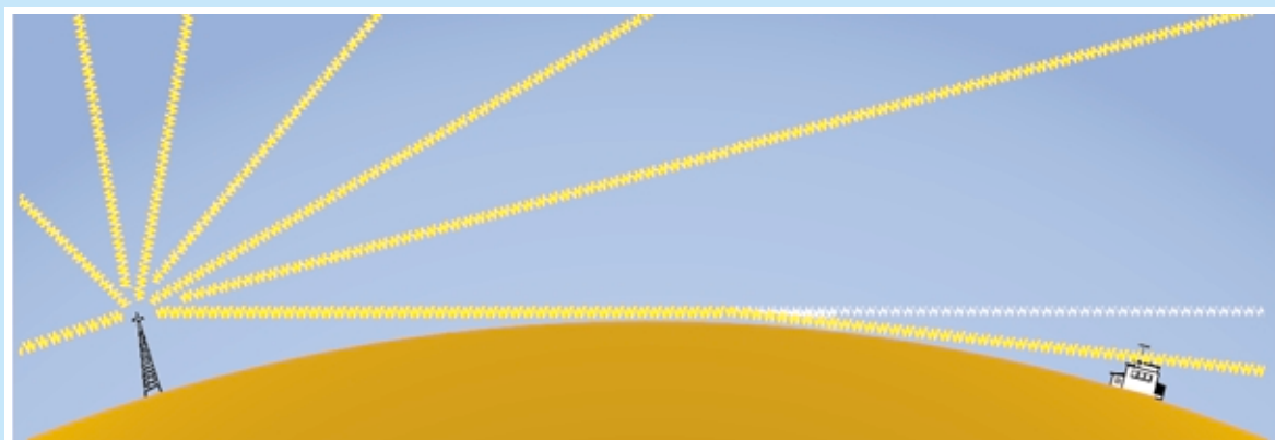
Fig.290 Le “onde di terra” non seguono mai una linea retta, perché attratte verso il suolo dal campo magnetico terrestre. Un’antenna emittente posta ad un’altezza di 300 metri dal livello del mare ha un “orizzonte ottico” di circa 60 km, ma per effetto dell’attrazione del campo magnetico terrestre queste onde radio riescono a raggiungere distanze maggiori.
