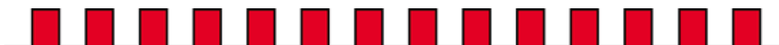
Fig.348 Per evitare che il diodo ricevente possa essere influenzato da segnali spurii all'infrarosso emessi da altre sorgenti, il fascio emesso dal diodo trasmittente viene modulato con un segnale ad onda quadra la cui frequenza si aggira sui 7.100-7.500 KHz .
