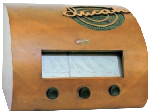
Fig.373 Verso il 1939-1940 in ogni ricevitore venne inserita una "scala parlante" con inciso il nome di tutte le emittenti operanti sulle OM. In questa foto, una vecchia supereterodina costruita dalla Ducati di Bologna negli anni 1940-1946.
