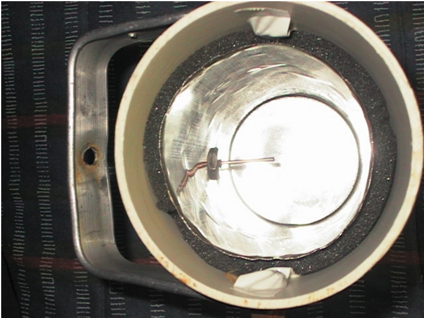
Figura 5: Antena terminada, instalada y apuntada. Nótese la inclinación que lleva. Esto es así porque el foco en esta parábola no se encuentra en el centro, sino más hacia abajo. Otro dato a tener en cuenta es que esta antena (en la foto) está apuntada a un cerro que mide 1000 m sobre el nivel del suelo. Si tuviésemos que apuntar a un lugar más nivelado, debería estar más inclinada hacia abajo aún.
