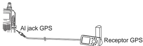
Para usar el receptor GPS conectado, accede al Menú 2-2 (GPS UNIT) y seleccione "NMEA" o "NMEA96". El ajuste por omisión es "NOT USED" (no utilizado). Seleccione "NMEA96" cuando utilice un receptor GPS de 9600 bps.
