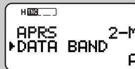
**Nota:** En el Menú 2-M, las opción cambia entre A, B, A:TX B:RX, y A:RX B:TX. Seleccione A:TX B:RX o A:RX B:TX si redes APRS que utilicen dos frecuencias diferentes se hacen disponibles en el futuro. Aparece "A" como banda de transmisión de datos y "B" como banda de recepción de datos.
