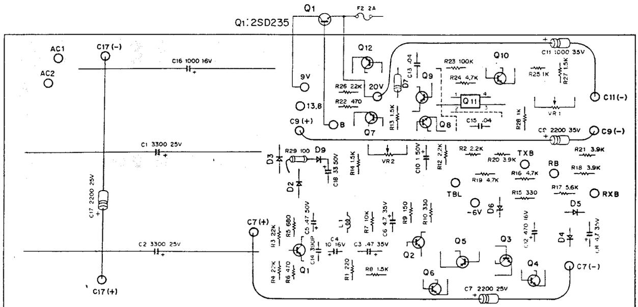
Q1,3,10: 2SC733(Y), Q2,7,8: 2SC734(Y), Q4,12: 2SD235(Y), Q5: 2SB405(R), Q6: 2SA671TD(B), Q9: 2SA495(OorY), Q11: MFC4060A, D1: DS-10BN-L, D2,3: U05B, D4,5,7: V06B, D6: WZ061, D9: 1N60,
