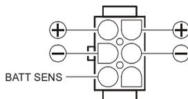
Cette prise permet également de commander la puissance de sortie. Si vous mettez la broche 3 (BATT SENS) de la prise alimentation DC à la masse, le **FT-857** passe automatiquement à 20 Watts (10 Watts sur 430 MHz) de puissance de sortie.
