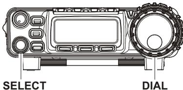
Le pas d’incrément du synthétiseur pour le bouton **SELECT** peut être ajusté indépendamment par mode. Utiliser le menu n° 006 [AM STEP] pour l’AM, n° 052 [FM STEP] pour la FM,
